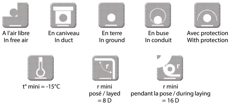
Sans protection mécanique complémentaire, ces câbles peuvent être installés fixés aux parois, sur un chemin de câbles, ou une échelle à câbles. Dans les locaux soumis aux risques d'explosion, ils seront installés avec une protection appropriée. Dans ce cas, réduire les intensités de 15 % conformément à la NF C 15-100.
